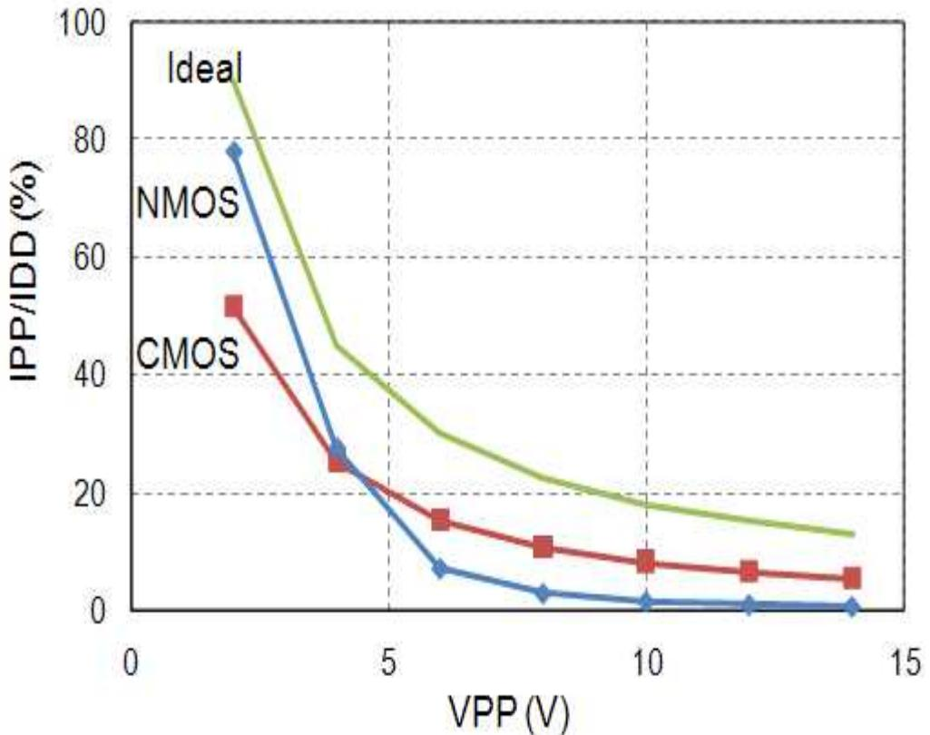
Charge pump의 효율은 IPP/IDD로 정의하는데 아래 그림 3.2는 이상적인 charge pump와 비교해서 NMOS type과 CMOS type의 charge pump 효율을 simulation하여 비교한 것이다[7].
