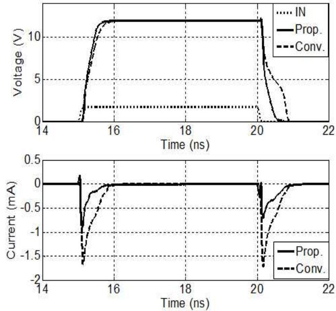
그림에서 보는 바와 같이 제안된 level shifter는 PMOS pull-up 전류를 regulation하기 때문에 기존의 level shifter와 비교해서 delay, 전력소모 면에서 모두 개선되었고, VPP 전압이 12V에서의 PDP는 약 3.7 배 우수한 것으로 나타났다.
