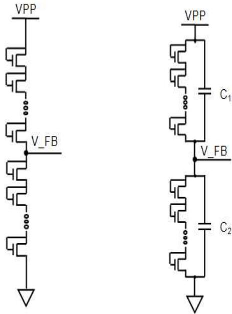
그림 3.4(a)는 diode-connected NMOS chain을 이용한 VPP divider를 (b)는 diode-connected NMOS chain과 capacitor를 이용한 RC coupled VPP divider를 보여준다.
