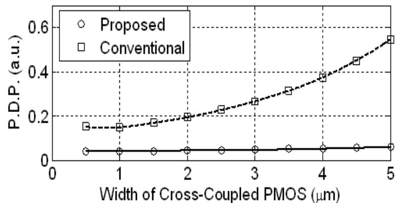
그림 3.9에서 보는바와 같이 기존의 level shifter는 PMOS 크기에 따라 그 특성이 크게 변하지만 제안된 level shifter는 cross-coupled PMOS의 전류가 regulating 되기 때문에 크기의 영향을 거의 받지 않고 보다 더 좋은 성능을 내는 것으로 나타났다. 또한 level shifter는 pull-up 할 때와 pull-down 할 때의 delay, 전력소모가 다르게 나타날 수 있기 때문에 level shifter를 설계할 때 그러한 부분을 고려하여 설계해야 한다. 그림 3.10은 PMOS 크기에 따라 기존의 level shifter와 제안된 level shifter에서 pull-up, pull-down 시 PDP 성능을 조사한 그래프이다.
