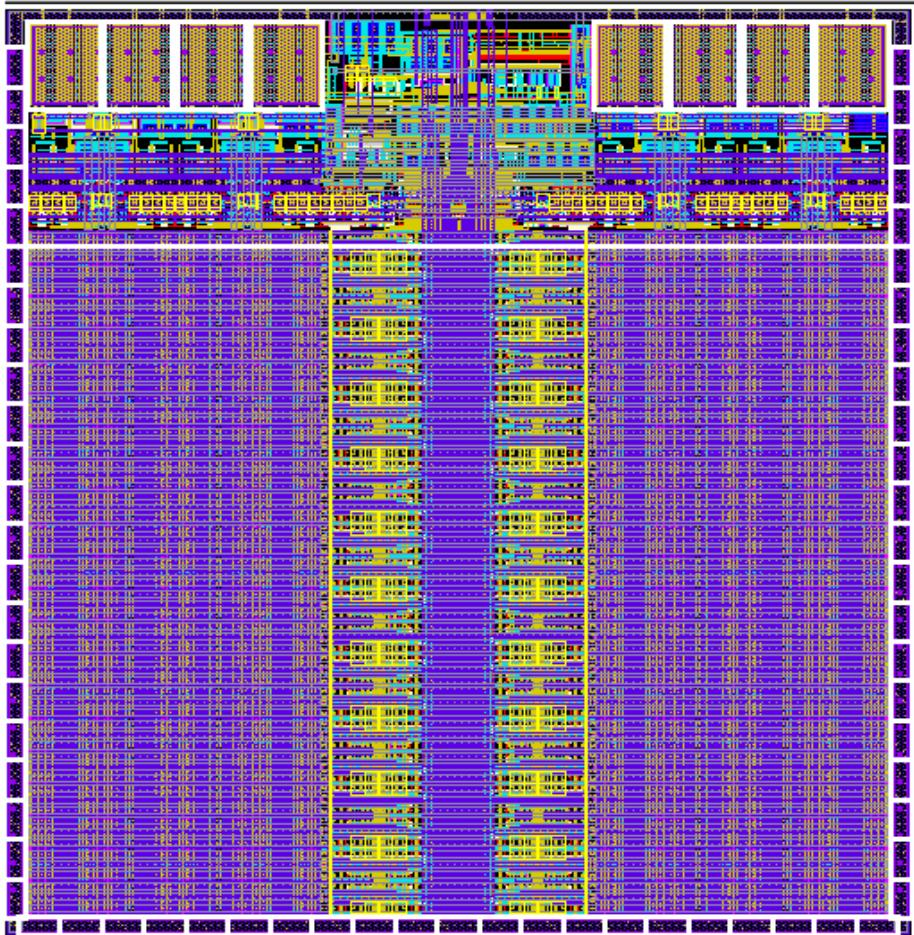
Voltage up-converter 의 부하로서 동작하는 level shifter 는 그 동작시 많은 양의 short circuit current 발생하는데, 본 논문에서는 cross-coupled PMOS 와 cascode protection NMOS 사이에 bootstrapped PMOS 를 삽입하여 short circuit current 를 없애고, delay 특성을 크게 개선시켰다. 제안된 level shifter 는 기존의 level shifter 가 가지는 해결하고 VPP 12V 에서 PDP 특성은 약 3.7 배 향상시켜 VPP power 를 20.2uW 로 줄였다.
