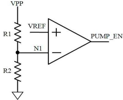
Op-Amp의 입력으로 쓸 수 없기 때문에 적당한 전압으로 낮춰서 기준전압(VREF)과 비교하여 출력을 내보낸다. Charge pump에 의해 VPP 전압이 올라가면 N1 노드 전압도  $VPP \times R2 / (R1 + R2)$ 만큼 상승하게 된다. N1의 노드전압이 VREF의 전압보다 높으면 Op-Amp는 charge pump로 PUMP\_EN(disable signal)을 출력으로 내보내어 charge pump를 꺼준다. 반대로 N1의 전압이 VREF 보다 낮다면 PUMP\_EN(enable signal)을 charge pump로 보낸다.
