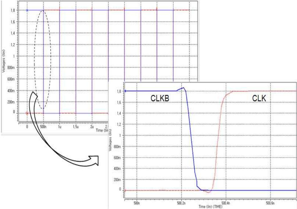
Charge pump의 전하 흐름이 한 방향으로 흘르게 하기 위해서 diode의 switch 역할을 맡고 있는 clocking 신호인 CLK와 CLKB는 반드시 서로 non-overlapping 이 되어야 한다. 만약 두 clock 신호가 서로 overlap 되는 구간이 존재한다면 인접한 두 diode가 켜져 reverse current가 발생하여 pump 동작이 이루어지지 않는다. 그렇기 때문에 그림 4.1에서 보는바와 같은 non-overlapping 회로가 필요로 한다. CLK, CLKB 신호가 overlap 되지 않도록 inverter를 이용하여 delay를 주었고 그림 4.2에서 보는바와 같이 simulation으로 그 동작을 확인하였다. Inverter를 이용하여 충분한 delay를 주었다 하더라도 charge pump의 stage 개수가 늘어남에 따라 inverter의 loading이 늘어나 CLK, CLKB의
