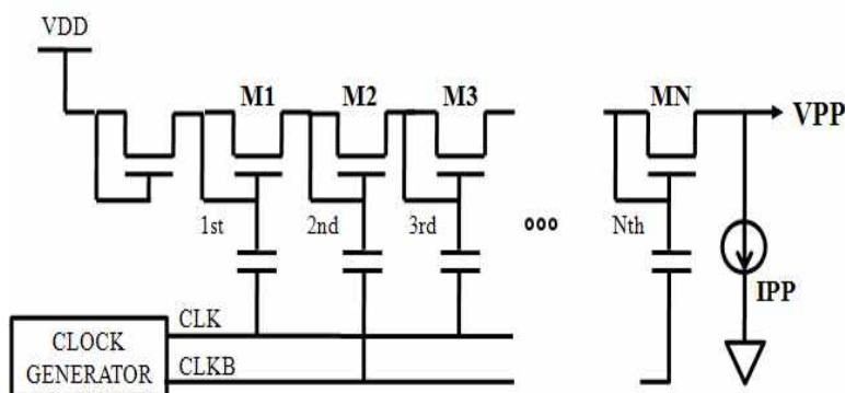
Diode-connected NMOS로 이루어진 charge pump의 경우 charge가 각 stage를 넘어갈 때마다 문턱전압( $V_t$ )만큼의 전압강하가 일어난다. 또한 Diode-connected NMOS의 바디가 모두 VSS로 루여있기 때문에 body effect도 고려해야 한다. stage가 커지면 커질수록  $V_{BS}$ 가 커지기 때문에  $V_t$ 역시 증가한다.  $V_t$ 가 VDD만큼 커지는 일정 stage에 도달하게 되면 더 이상 VPP 전압은 증가하지 않아 그 효율이 급격하게 떨어진다. 식 (2.1)은 NMOS type의 Dickson's charge pump에서 최종적으로 얻게 되는 VPP 전압이다[4].
