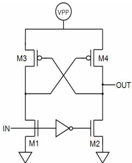
PMOS의 크기에 따라 level shifter의 성능이 결정되는데, PMOS의 크기는 반드시 NMOS의 크기보다 작아야 한다. Pull up 속도를 빠르게 하기 위해 PMOS의 크기를 크게 하면 스위칭 동작을 할 때, pull down 하는 NMOS 와 서로 충돌하기 때문에 VPP에서 VSS로 흐르는 short circuit current 가 발생하게 된다. 이러한 short circuit current 는 charge pump 동작에 큰 영향을 미쳐 system의 효율을 급격하게 떨어뜨리게 하는데 VPP/VDD 비율이 크면 클수록 short circuit current 의 양이 늘어난다. 또한 PMOS의 크기가 NMOS의 크기보다 크다면 pull down 하는 속도에도 영향을 주고 심지어 level shifting 동작을 하지 못할 수 있다.
