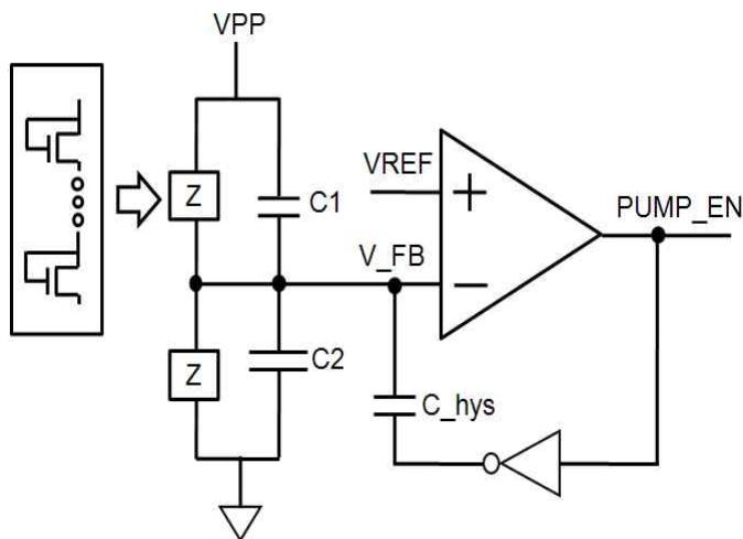
그림 3.6의 VPP detector에서 divider의 트랜지스터들은 모두 sub-threshold 영역에서 동작한다. 저항 역할을 하는 트랜지스터들은 capacitor로만 이루어진 divider의 floating 노드를 잡아주는 역할을 하고 실제 VPP 전압변화의 감지는 capacitor C1, C2의 크기 비율에 의해 이루어진다. Charge pump로부터 만들어진
