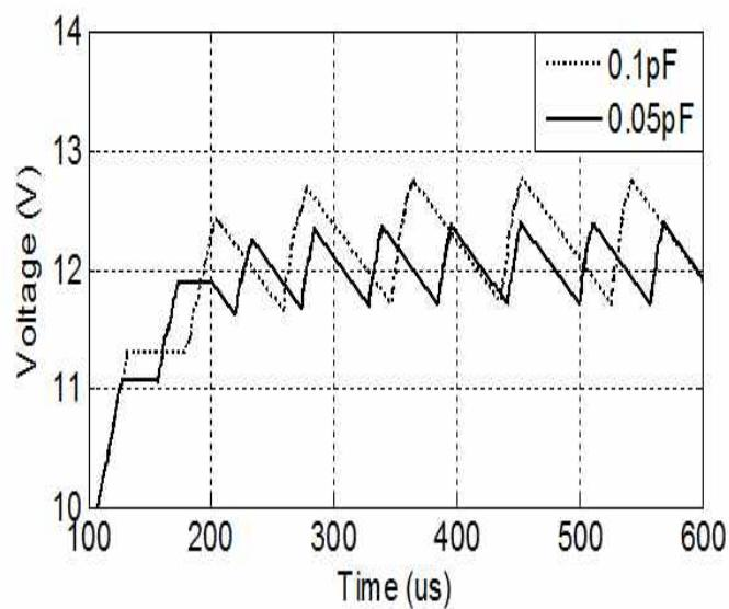
그림 4.5(a)는 divider의 트랜지스터가 sub-threshold 영역에서 동작할 때와, saturation 영역에서 동작할 때 보여주는 regulated VPP이다. Saturation 영역에서 동작할 때의 VPP는 매우 좋은 regulation 특성을 보이지만 앞장에서 설명하였듯이 VPP 누설전류가 많기 때문에 효율이 좋지 않고 sub-threshold 영역에서 동작할
