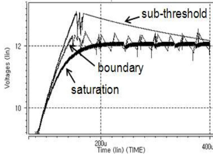
동작시킨다면 그 저항 값이 작아 VPP 누설전류가 커서 charge pump 효율을 나쁘게 한다. 그럼 3.5(a)는 divider 의 트랜지스터의 동작 영역에서의 흐르는 전류를 나타내고 (b)트랜지스터의 동작 영역에 따라 VPP detector에서의 regulate 되는 VPP 전압을 보여준다.
