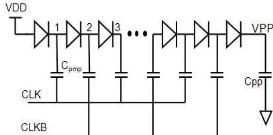
CLKB 가 'low' 상태가 되면 1 번 노드는 pumping capacitor( $C_{pmp}$ )를 통한 coupling 으로 인해 약  $2VDD$  까지 올라간다. 양단간의 전압 차이에 의해 1 번과 2 번 노드사이에 있는 다이오드는 켜지게 되어 첫 번째 capacitor에 저장되어 있는 전하가 두 번째 capacitor로 넘어가면서 2 번 노드의 전압은 그만큼 더 상승하게 된다. 반대로 CLK 가 'low' CLKB 가 'high' 상태가 되면 1 번과 2 번 노드 사이에 있는 다이오드는 꺼지고 2 번과 3 번 노드에 있는 다이오드는 켜지게 되어 두 번째 capacitor에 저장된 전하는 세 번째 capacitor로 전달된다. 전원으로부터 공급되는 전하는 각 stage 의 다이오드가 켜지고 꺼지는 방식으로 최종적으로 끝단의  $C_{pp}$ 에  $VPP$  전압만큼 쌓이게 된다.
